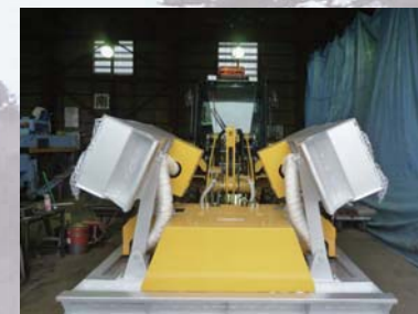
路面ヒーター14台
