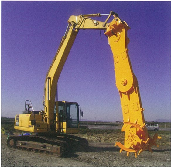
ブーメランプレート装着でN値38の礫混じり砂層に対応
